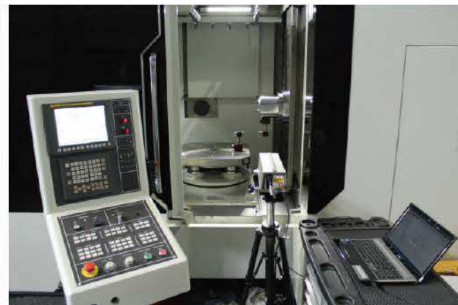
Laser Calibration 雷射補正測試
